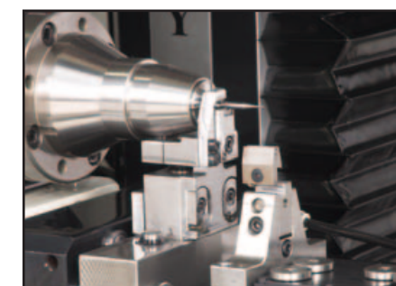
刀具支撐裝置 (V型塊支撐和金手指壓板)
